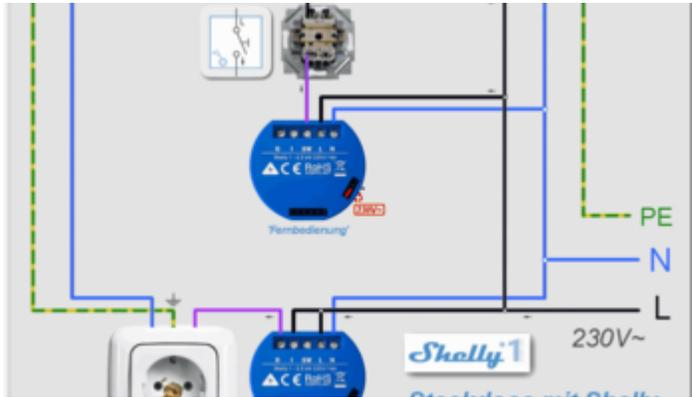
'**Fernbedienungs-Shelly**' werden dabei irgendwo im Raum (oder sogar einem anderen) z.B. hinter dem Schalter montiert. Es wird **N, L und der Schaltdraht** benötigt.
